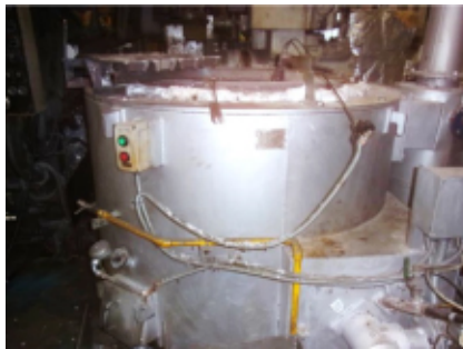
設置前のアルミ溶解炉（左）/アルミ溶解炉の周囲にファインシュライトを設置（右） （詳細は こちら ）
