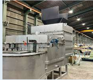
遮熱塗料を用いた金型、設備輻射熱の低減
