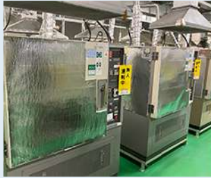
自社開発断熱材（ファインシュライト®）を用いた乾燥炉断熱仕様
