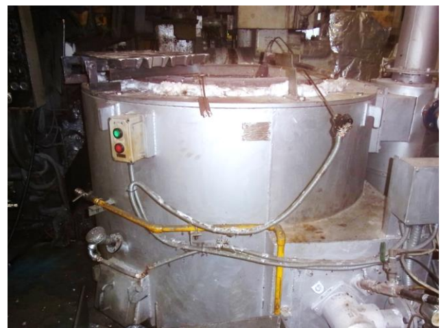
アルミ溶解炉の周囲にファインシュライトを設置（左）／設置前のアルミ溶解炉（右）
