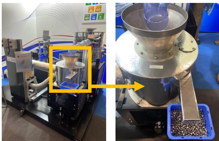
洗浄機に貼り付けたファインシュライト (アルミ蒸着フィルムタイプ)
