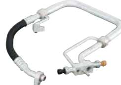
7 エアコンホース
