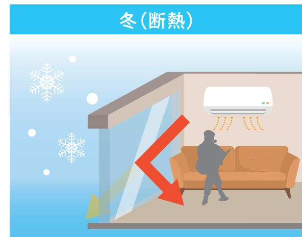
暖房熱の流出を約32%抑制します。
