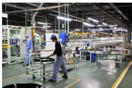
単長 60メートルの高圧ホース製造ライン
