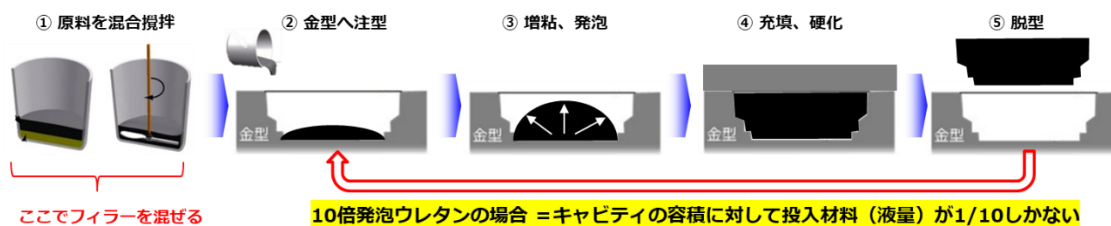
図3 発泡ウレタンの成形プロセス
