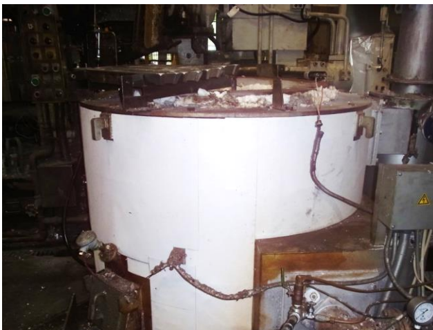
アルミ溶解炉の周囲にファインシュライトを設置（左）／設置前のアルミ溶解炉（右）
