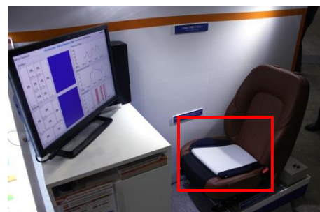
SRセンサ内蔵のクッションをシートに設置
