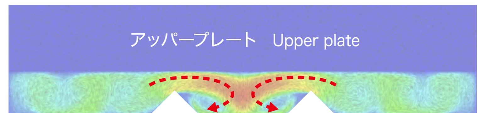
冷却水が突起によって攪拌される
