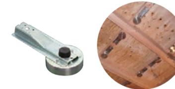
通过弹簧、质块及高阻尼橡胶的复合减震效果，来降低小孩的蹦跳等带来的生活噪音。消除公寓或2代人住宅产生的上下楼间的地板冲击声。
