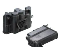
主要配置于油箱周边，可反复吸附和释放汽油蒸汽。符合全球最高等级的汽油蒸发法规。
