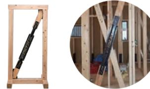
减少地震时木造住宅的损伤的减震系统。将地震能量瞬间转换成热能以降低摇晃。适用于新建以及现有住宅的改造，对于余震等重复地震，也有望发挥显著的效果。
