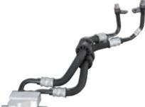
用在非常严苛的热环境下，要求具备良好的高耐热性。将自动变速器性能发挥到极限，为改善汽车油耗做贡献。用于需要将传动的温度保持在一定温度的回路中。
