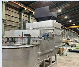
使用隔热涂料减少模具和设备的辐射热
