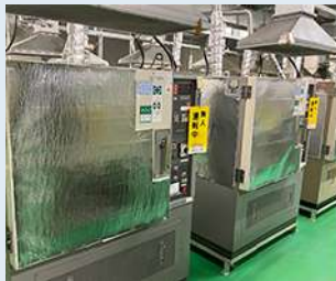
装设本公司开发的绝热材料（Finesulight®，图右）的干燥炉
