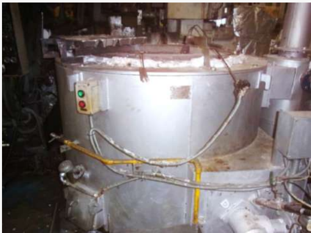
铺设绝热薄膜前的铝熔铝炉（左）/在熔铝炉周围铺设Finesulight绝热薄膜（右）
