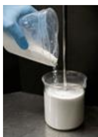
写真2 多糖類を使用して水中に分散したシリカエアロゲル
